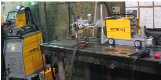
Postavitev opreme za atestno varjenje etalonov
